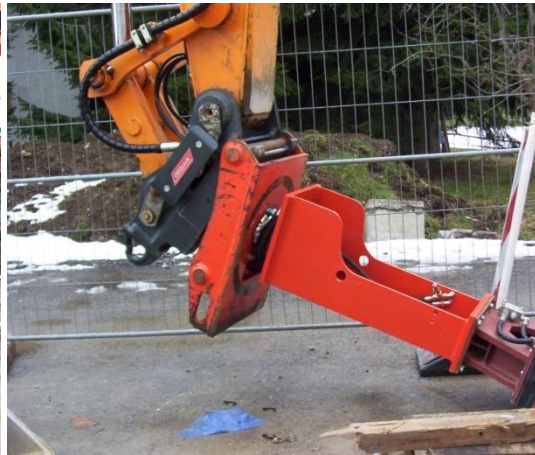
OilQuick сэндвич на системе Lehnhoff MS 25 для крепления имеющегося оборудования
