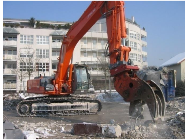
OilQuick с сортировочным грейфером и гидравлическим измельчителем
