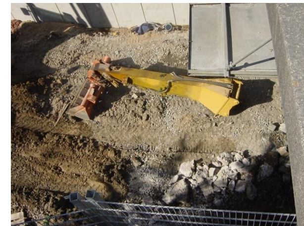
OilQuick OQ 70/55 удлинение оборудования при помощи дополнительной стрелы
