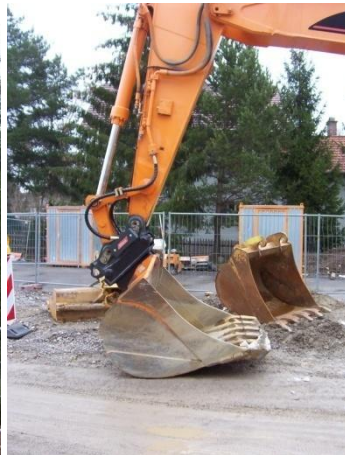
OilQuick сэндвич на системе Lehnhoff MS 25 для крепления имеющегося оборудования
