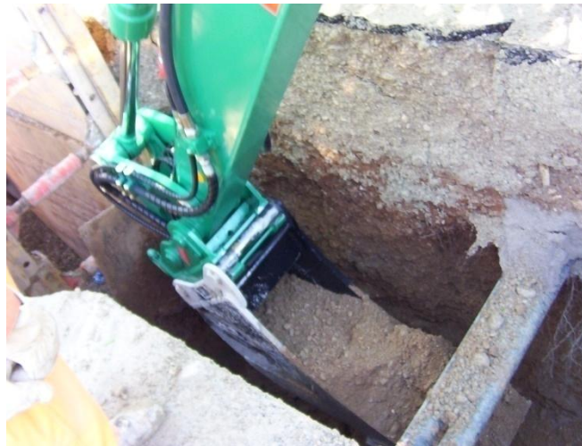
OilQuick OQ 70/55 работа в траншее, с фрезой и методом обратной лопаты
