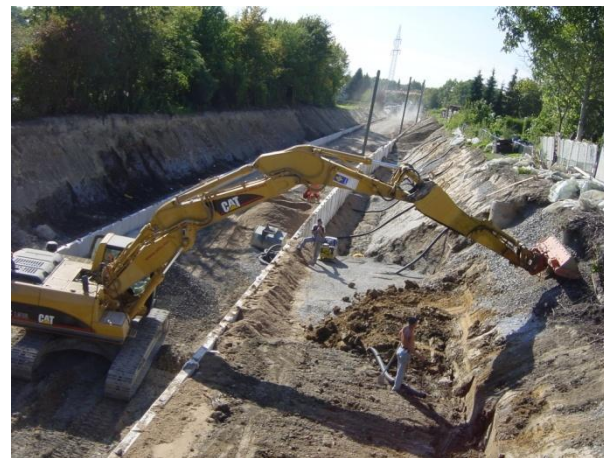
OilQuick OQ 70/55 удлинение оборудования при помощи дополнительной стрелы
