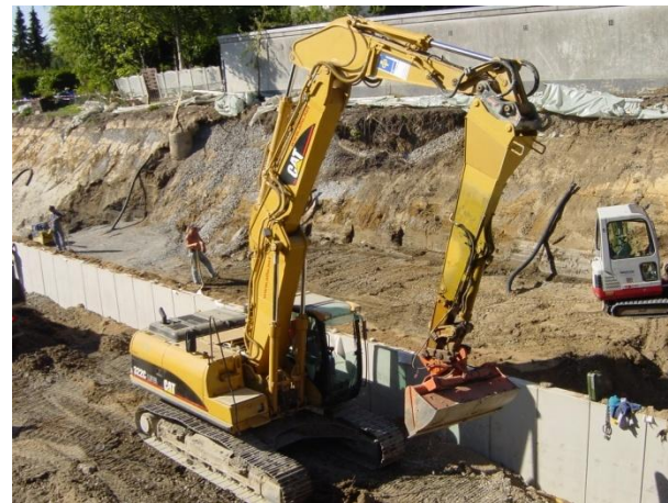
OilQuick OQ 70/55 удлинение оборудования при помощи дополнительной стрелы
