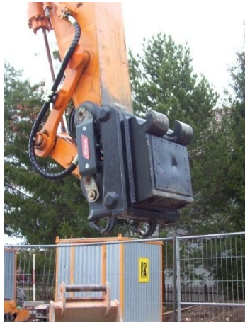
OilQuick сэндвич на системе Lehnhoff MS 25 для крепления имеющегося оборудования
